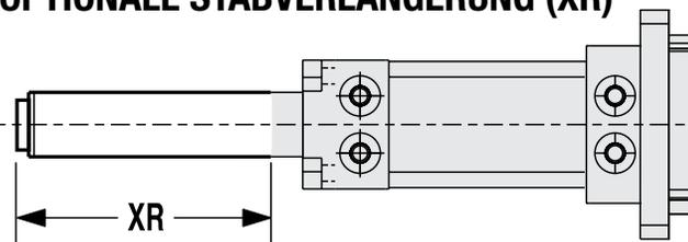
Die Schubstange kann durch Angabe der Stangenverlängerungsoption verlängert werden. Dabei wird nicht der Arbeitshub, sondern nur die Länge der Schubstange vergrößert.
