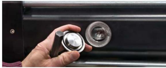
Entfernen Sie die Zugangsabdeckung und fahren Sie die Schubstange aus oder ein, um Zugang zum internen Schmiernippel zu erhalten.
