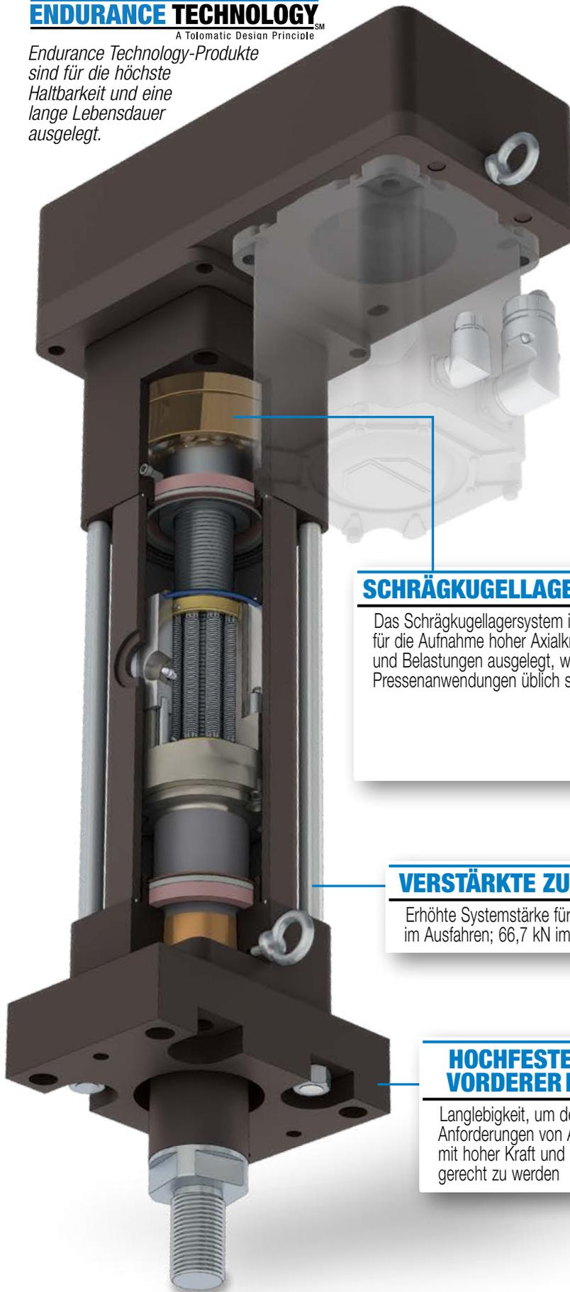
Das Pressmodell RSX23P & RSX33P erweitert die Kraftkapazität auf 205 kN & 294 kN und eignet sich daher besonders für Anwendungen wie Pressen, Nieten, Clinchen und viele andere. Das Pressmodell verfügt über alle Eigenschaften des Standard-RSX auf den Seiten 4 und 5 sowie Verstärkte Zugstangen, ein für hohe Dehnkräfte optimiertes Lagersystem und einen Vorderflansch aus hochfestem Stahl.
